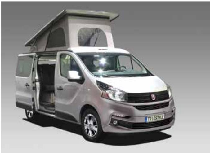
Gasfederunterstützt, Dachaufstellung vorne hoch. Inklusive Frontspoiler. Fahrzeughöhe inklusive Schlafdach ca. 207 cm. Mit Front- und 2 Seitenfenstern. Die Front kann mit Reißverschluss geöffnet werden. Seitenfenster mit Moskitonetzen. Himmel (100% Polyester), Zeltbalg grau (100% Baumwolle). Stehhöhe vorn 225 cm, hinten 140 cm. inklusive Einbaurahmen Mit Teilegutachten\*.
