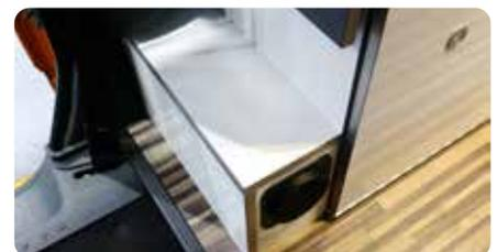
**Einbaukasten für Standheizung**
