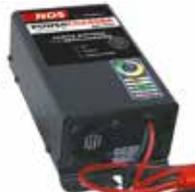
LED-Ladephase-Anzeige. Bei Batterien mit Leistungsverlust lässt sich die Sulfatierungsfunktion zuschalten und mittels Impulsladung die Sulfatschicht aufbrechen. So wird die nutzbare Kapazität der Batterie wieder erhöht. Teilsulfatierte Batterien können dadurch erheblich in ihrer Leistungsfähigkeit regeneriert werden. Vollsulfatierte defekte Batterien werden sich jedoch nicht regenerieren lassen. Maße: (L x T x H) 270 x 165 x 120 mm
