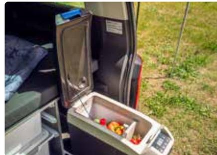
Die optionale 16-l-Kompressor-Kühlbox ist herausziehbar sowie herausnehmbar und wird vom 12-V-Bordnetz gespeist.
