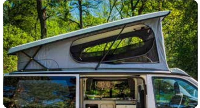
Dieser neue Zeltbalg besteht aus einem neuem, speziell für diese Anwendung entwickelten Synthetik-Material. Dieses zeichnet sich durch verbesserte Wetterfestigkeit, Atmungsaktivität und Dauerhaftigkeit sowie leichtere Pflege aus.
