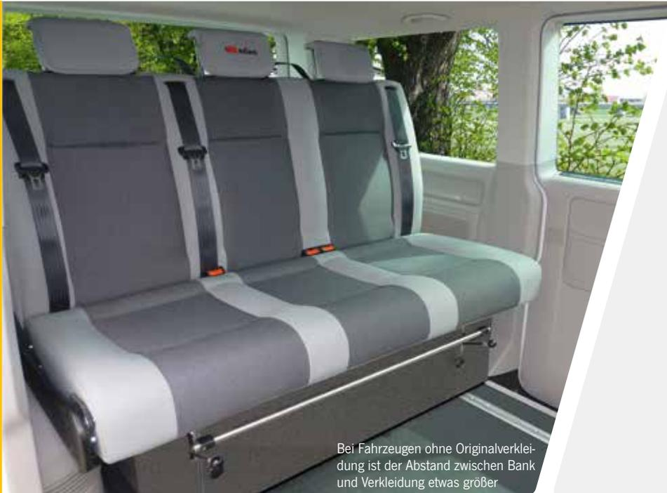
Bei Fahrzeugen ohne Originalverkleidung ist der Abstand zwischen Bank und Verkleidung etwas größer
