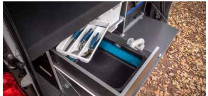
Die multifunktionale CampingBox WV wird in das Heck des Fahrzeugs gestellt und in den Bodenschienen verschraubt. Die Heckablage der Sitzbank wird herausgenommen, das Original Heckpolster liegt dann auf der Campingbox auf und ergibt mit der Sitz- Schlafbank eine ebene Liegefläche.
