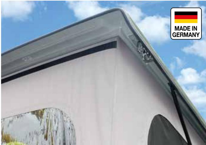
Das neue Easy Fit V-Tec Schlafdach ist eine Sandwichkonstruktion aus Innen- und Außenschale, leicht und stabil mit integrierten Verstärkungen. Der Sicherheitsverschluss ist durch die Schale verschraubt. Elegante glatte Oberfläche innen wie außen, leicht zu reinigen. Inkl. Einbaurahmen
