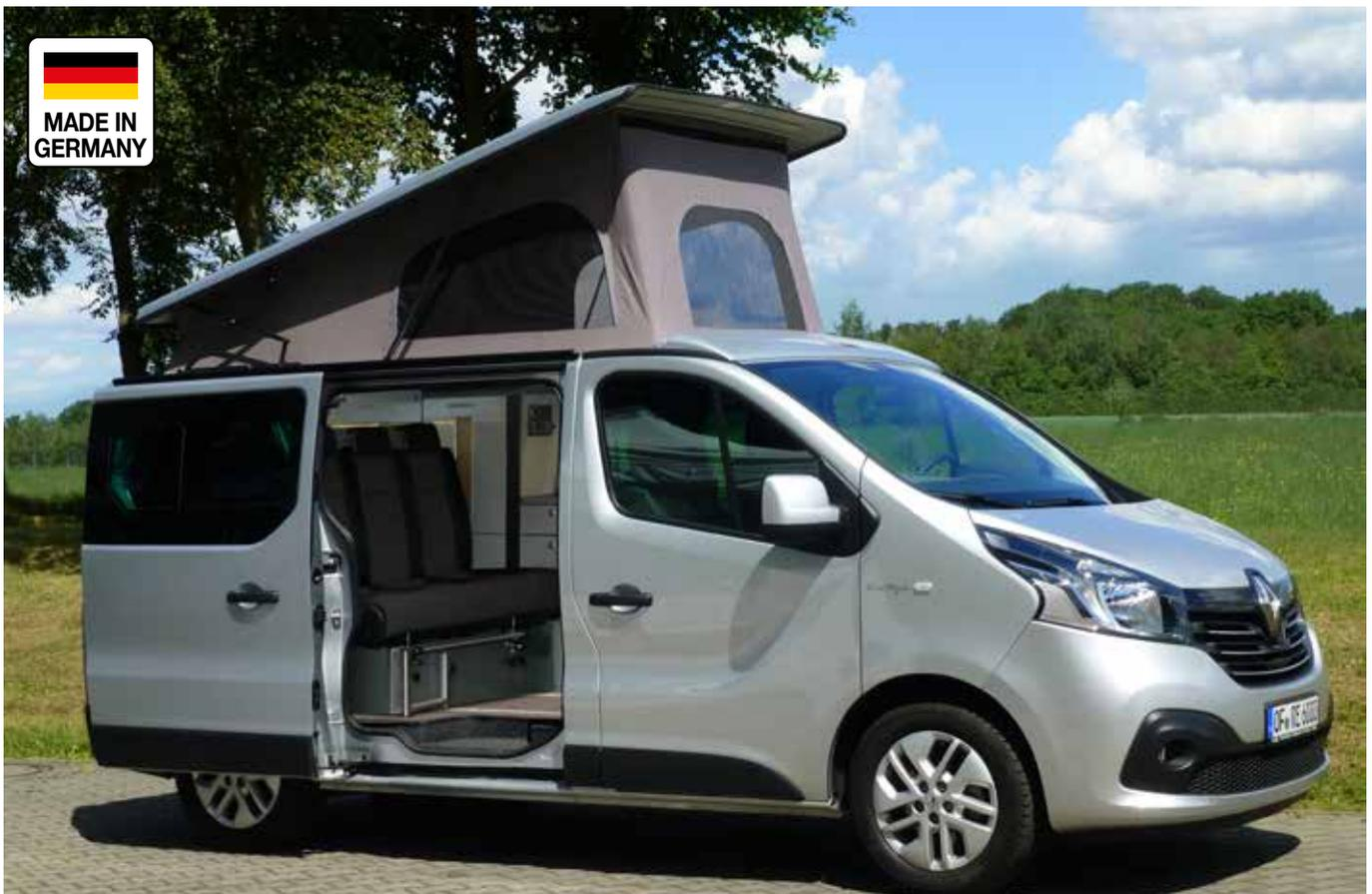
Gasfederunterstützt, Dachaufstellung vorne hoch. Mit Front- und 2 Seitenfenster. Die Front kann mit Reißverschluss geöffnet werden. Seitenfenster mit Moskitonetzen. Himmel (100% Polyester), Zeltbalg grau (100% Baumwolle), inkl. Einbaurahmen. Dachschalenfarbe Weiß. Mit Teilegutachten\*.
