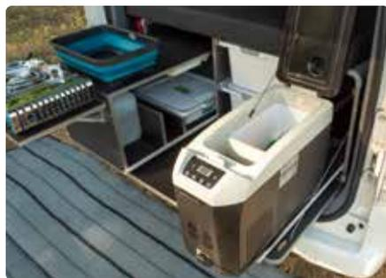
Die 16-l-Kompressor-Kühlbox ist herausziehbar sowie herausnehmbar und wird vom 12-V-Bordnetz gespeist.
