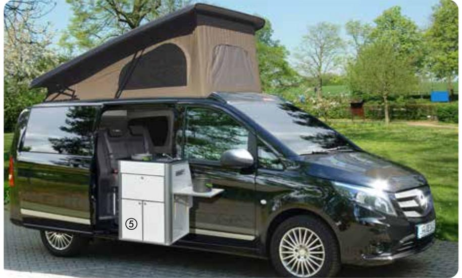
Schwenkküchenteil zum Einbau hinter dem Beifahrersitz im Mercedes Vito. In Verbindung mit einer Reimo-Schlafbank V3000 ist die volle Bettlänge nutzbar.
