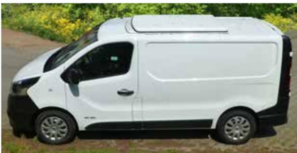
Neues Hubdach mit Easy Fit Unterrahmen und integriertem Frontspoiler. Der Easy Fit Unterrahmen ermöglicht die perfekte Anpassung an die Dachstruktur des Fahrzeugs. Das Dach bietet Stehhöhe in einem Bereich von 98x92 cm. Fahrzeughöhe bei geschlossenem Dach ca. 203 cm.
