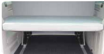
(Stauraumhöhe unter Heckpolster: 46 cm), Frontblende und Seitenblende. Fertig gepolstert inkl. Heckpolster. Bank verschiebbar und herausnehmbar. Schienenabstand 997 mm Stoff-Design:
