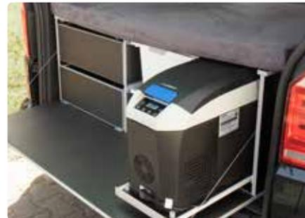
Die 16l-Kompressor-Kühlbox (optional) ist herausziehbar sowie herausnehmbar und wird vom 12-V-Bordnetz gespeist.
