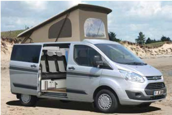
Dachaufstellung vorne hoch. 3 Fenster im Zeltbalg, Moskitonetze herausnehmbar. Zeltbalg 100% Baumwolle. Bettmaße: ca. 203 x 130 cm. Stehhöhe bei geöffnetem Dach: 205 cm vorne, 150 cm hinten. Zeltbalg montiert. Ohne Rahmen, ohne Bett. Separat erhältlicher Einbaurahmen zur Verstärkung erforderlich. Einzelabnahme erforderlich.
