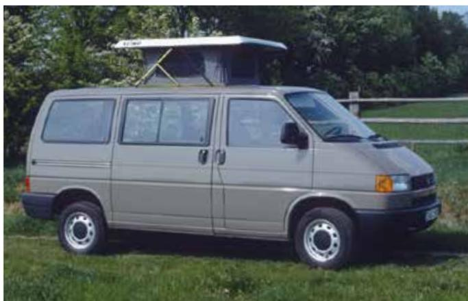
Stehhöhe im Eingangsbereich (bei geöffnetem Dach) ca. 190 cm. Dachaufstellung Gasfederunterstützt. 2 seitliche Fenster mit Moskitonetz, 1 in der Front integriertes Folienfenster. Inkl. Einbaurahmen. Fahrzeughöhe ca. 6 cm. Dachmaße ca.: L175 x B130 x H9 cm. Dachausschnitt ca. L107,5 x B101 cm. Zeltbalg 100% Baumwolle. Hubdach-Position zwischen B- und C-Säule. Dachschalenfarbe Weiß. Inkl. Teilegutachten\*. (Lieferzeit ca. 4-6 Wochen) **21210 1430,-**
