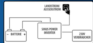
Reine Sinusspannung für empfindliche 230V Geräte
