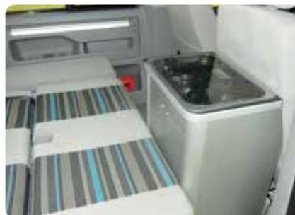
Küchenteil mit Kocher, Glasabdeckung und Technik. Anschlussfertig installiert und für den Einbau im Fahrzeug vorbereitet. Maße: H737 x B510 x T390 mm.
