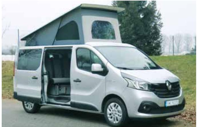
Gasfederunterstützt, Dachaufstellung hinten hoch. Mit Front- und 2 Seitenfenster. Die Front kann mit Reißverschluss geöffnet werden. Seitenfenster mit Moskitonetzen. Himmel (100% Polyester), Zeltbalg grau (100% Baumwolle), inkl. Einbaurahmen. Dachschalenfarbe Weiß. Mit Teilegutachten\*.
