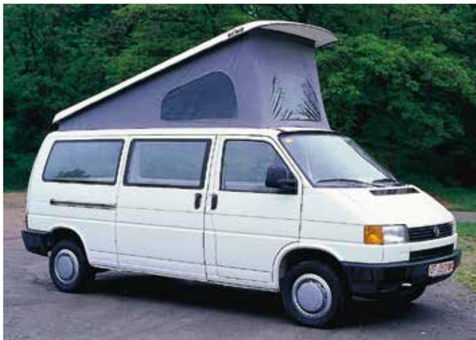
Gasfederunterstützte Dachaufstellung vorne hoch. Mit Teilegutachten\*. Stehhöhe bei geöffnetem Dach ca. 195 - 245 cm. Fahrzeughöhe ca. 6 cm. Integrierte Regenrinne. 3 Fenster im Zeltbalg (1 davon mit Folie), Moskitonetz mit Reißverschluss. Schlaflfläche ca. 200x120 cm. Zeltbalg 100% Baumwolle. Bezug 100% Polyester. Glasschiebedach und Solarzelle möglich. Verdeckte Aufnahme der Aktivschiene ohne zusätzliche Fahrzeughöhe möglich. Dachschalenfarbe Weiß. **21121 2699,-**
