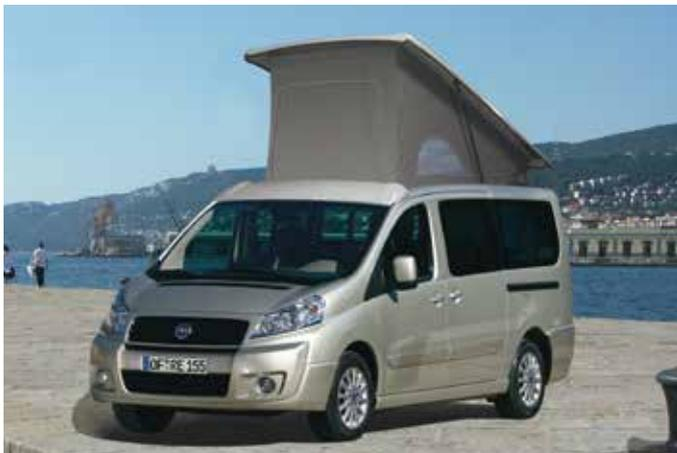
Schlafdach vorne hoch. Fahrzeughöhe ca. 200 cm. Schlafdach mit Frontteil, Dachschale in Gelcoat. Vorne ein großes Fenster (kann als Notausstieg genutzt werden). Seitlich 2 kleinere Fenster mit Moskitonetz. Ohne Teilegutachten. Einzelabnahme erforderlich.
